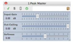
Peak master è un plug-in di base che riduce al minimo i picchi del file audio e consente un mixaggio a volume più alto senza clipping. È particolarmente utile per ridurre i picchi di strumenti molto dinamici.
