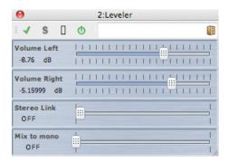
Leveler è utile per la correzione di sbilanciamenti o la regolazione di livelli tra i canali stereo, o ancora per il mixaggio a mono.
