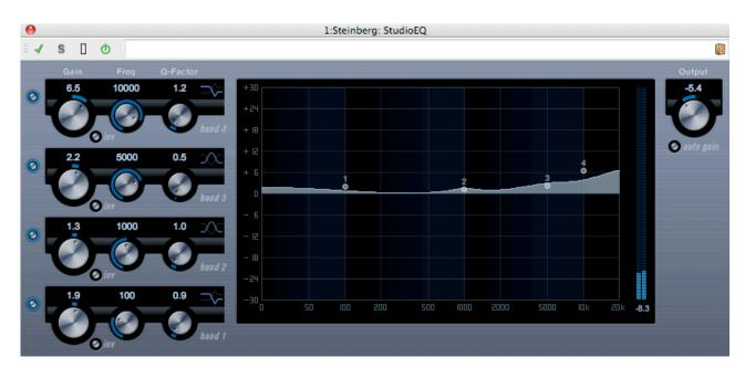
Equalizzatore stereo parametrico quadribanda di alta qualità, con due bande intermedie completamente parametriche. La banda alta e quella bassa possono funzionare come filtri di shelf (tre tipi), oppure come descrizione parametro, come filtro di picco (passa banda) o di taglio (passa-basso/passa-alto).
