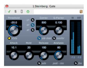
Il gating o limitazione del rumore silenzia i segnali audio al di sotto di un livello di soglia impostato. Quando il livello del segnale supera la soglia stabilita, il trigger Gate lascia passare il segnale.
