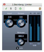
Limiter garantisce che il livello di uscita non superi mai una soglia preimpostata, per evitare il clipping nelle periferiche collegate. Limiter regola e ottimizza automaticamente il parametro Release [Rilascio] in base al materiale audio. In alternativa è possibile impostarlo manualmente. Inoltre Limiter dispone di indicatori di livello diversi per l'ingresso, l'uscita e la quantità di limitazione (indicatori centrali).
