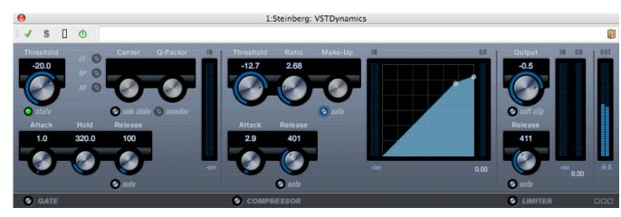
VSTDynamics è un processore dinamico avanzato. È una combinazione di tre processori diversi: Gate, Compressor [Compressore] e Limiter [Limitatore], che eseguono una vasta gamma di funzioni di elaborazione dinamica. La finestra è suddivisa in tre sezioni, contenenti controlli e indicatori di livello per ciascun processore.
