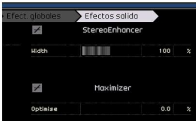
1. Mueva el deslizador “Maximizer” hasta que el efecto alcance un nivel adecuado.
