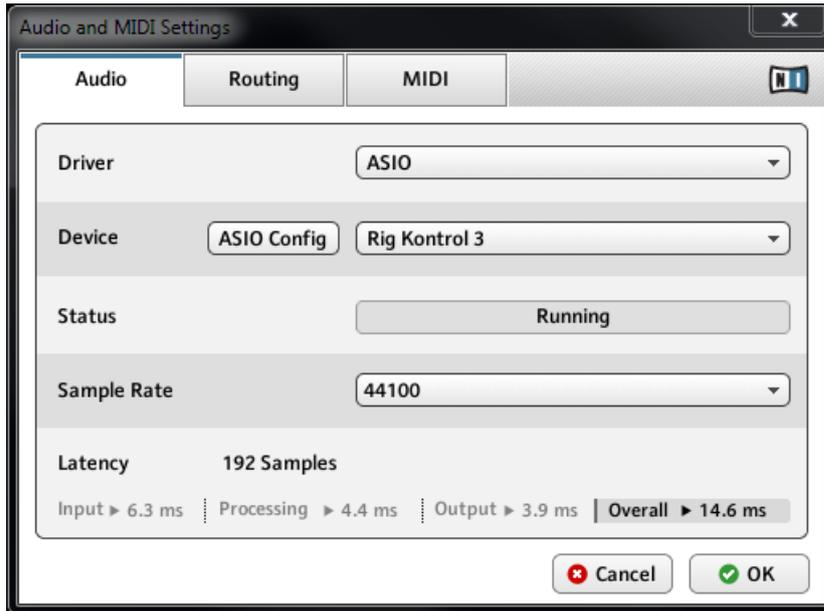
2. Dans le panneau de contrôle de votre matériel audio, sélectionnez une latence de sortie d'environ 10 millisecondes, ou 192 samples (échantillons). Cette valeur devrait fonctionner correctement sur la plupart des ordinateurs.
