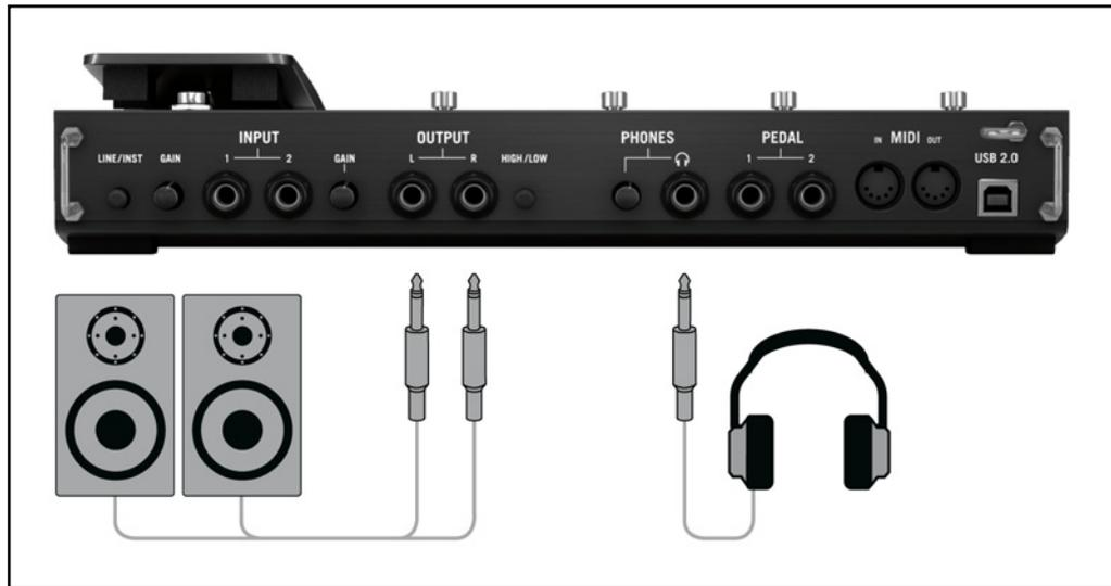
1. ボリュームを下げた状態で、アウトプットジャックをアンプのインプットに接続してください。
