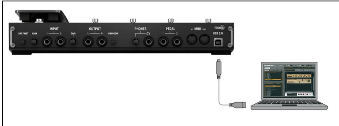
RIG KONTROL の電源供給源は USB です。この機器を正常に作動するには単体のUSB 2.0 コントローラー、または電源を供給するUSB 2.0 ハブの使用が必須です。
