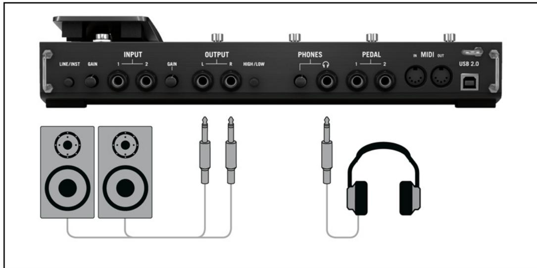
1. ボリュームを完全に下げた状態で、アウトプットジャックをアンプのインプットに接続してください。
