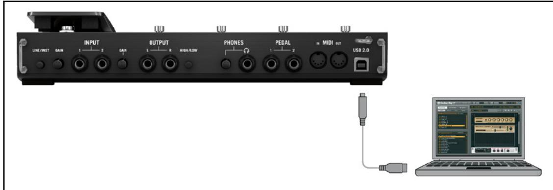
RIG KONTROL の電源供給源は USB です。この機器を正常に作動するには単体のUSB 2.0 コントローラー、または電源を供給するUSB 2.0 ハブの使用が必須です。Windows XP ではRIG KONTROL が正常に機能するために Service Pack 2 以上の環境が必要です。Windows のバージョンを確認するには”システムのプロパティ”をご覧ください。
