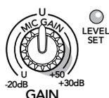
Sur les voies mono (entrée micro avec entrée ligne mono), le bouton de gain détermine la sensibilité des entrées ligne et micro.
