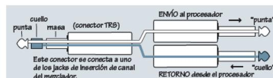
Los jacks de inserción pueden ser usados como salidas directas de los canales; post-ganancia y pre-EQ. Vea la sección de conectores en la página 30 (figura E) mostrando los tres modos de uso de los cables de inserción
