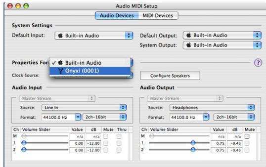
5. Aquí puede ver la configuración del mezclador. También puede seleccionarlo como su entrada o salida por defecto, así como designarlo para su uso como la salida de audio del sistema. Hay 8 canales de entrada de audio desde Onyx 820i, y 2 canales de salida de audio hacia Onyx 820i.
