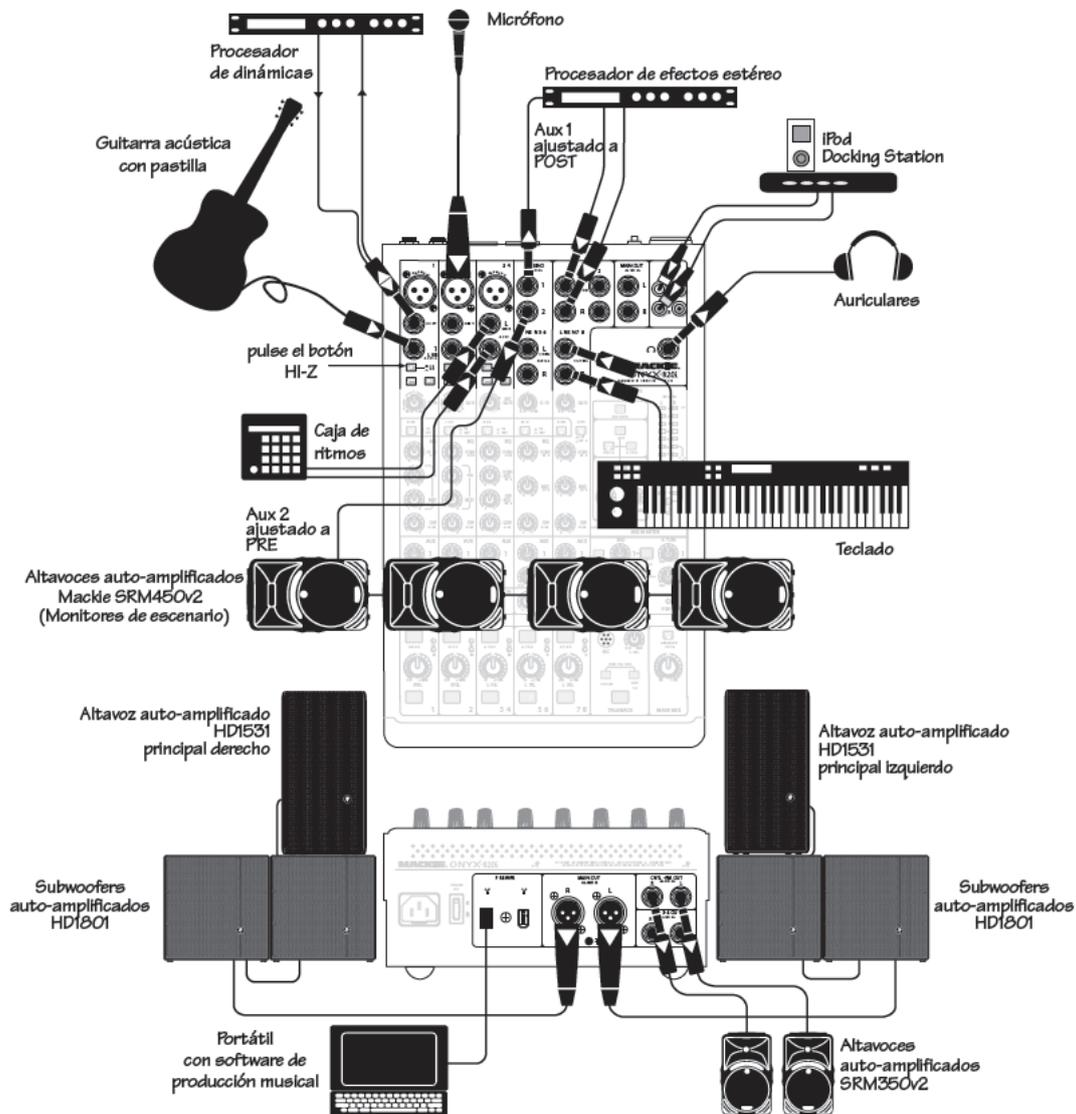
Este diagrama muestra una guitarra eléctrica en la entrada de línea del canal 1 (el conmutador HI-Z hacia adentro), un micrófono conectado a la entrada de micrófono del canal 2 una caja de ritmos a los canales 3-4, y un teclado a los canales 7-8. Habilite los conmutadores +4dBu/-10dBv en los canales 3-4 si la caja de ritmos va a -10dBv. Puede usar un iPod para música en las pausas.
