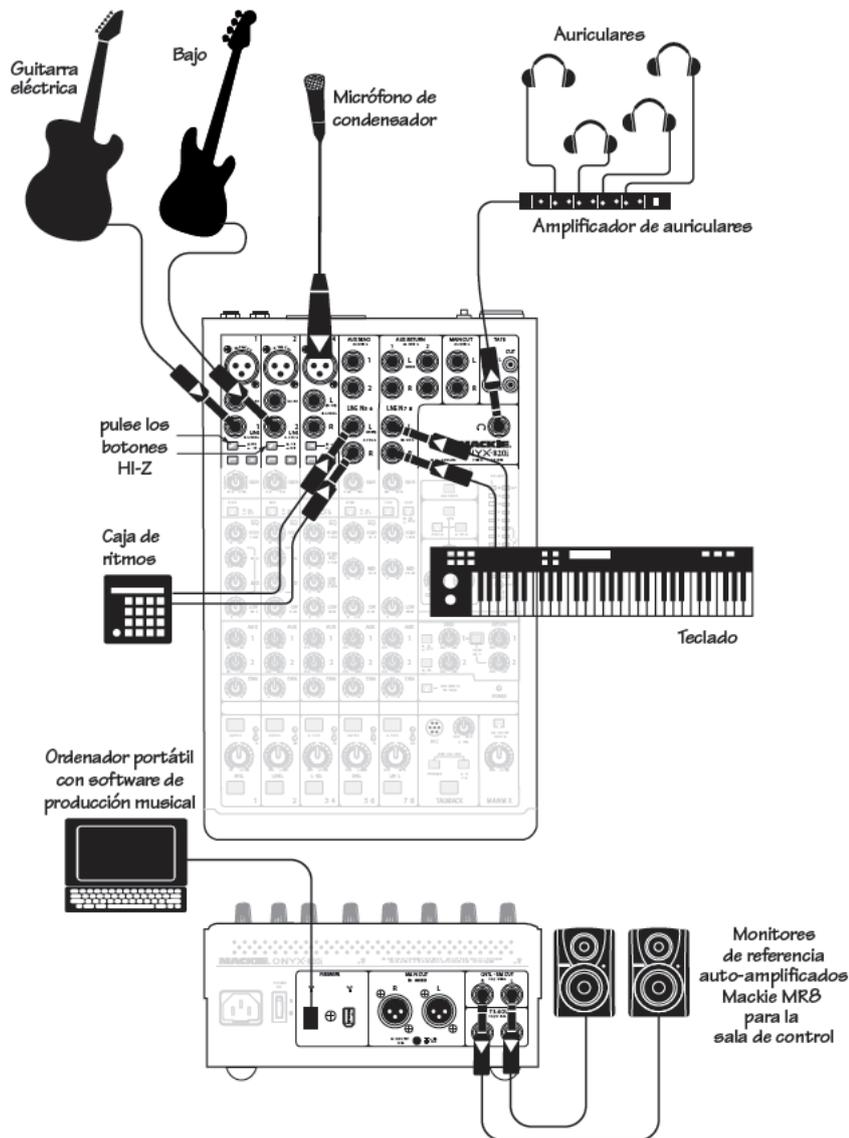
Este diagrama muestra una guitarra eléctrica conectada directamente al canal 1 (con el conmutador Hi-z habilitado), un bajo conectado directamente al canal 2 (también con Hi-z habilitado), un micrófono de condensador en el canal 3/4 con la alimentación phantom habilitada, una caja de ritmos conectada al canal 5/6, y un teclado conectado al canal 7/8. Un amplificador de auriculares permite el uso de múltiples auriculares durante la grabación.
