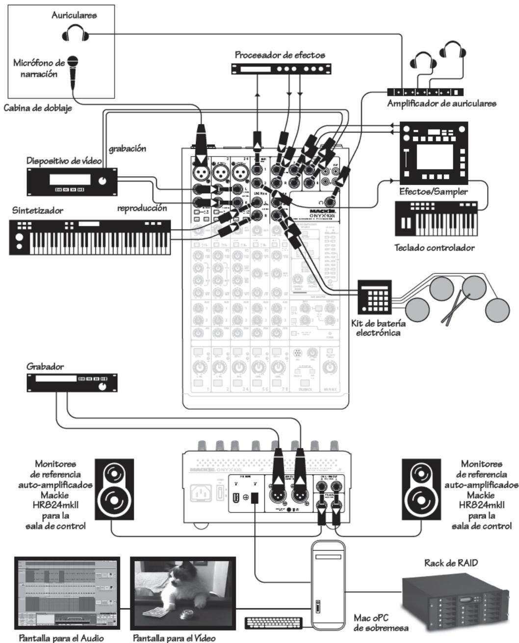
Este diagrama muestra una voz en off captada por un micrófono conectado a la entrada de micrófono del canal 1, las salidas de audio de un reproductor de video están conectadas a los canales 3/4, con sus entradas de audio recibiendo la mezcla principal desde las salidas principales en 1/4". Un sintetizador está conectado al canal 5 / 6, y en el canal 7/8 un kit de batería electrónica.
