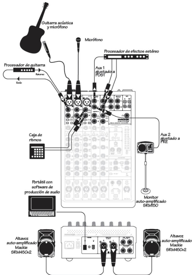
Este diagrama muestra una guitarra acústica captada por un micrófono conectado directamente al canal 1 y un micrófono para voces al canal 2. En el jack de inserción del canal 1 hay conectado un procesador para guitarras.
