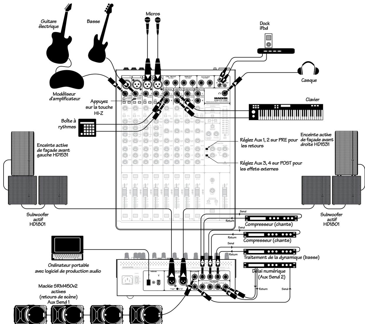
Ce schéma montre une guitare électrique connectée à l'entrée ligne de la voie 1 par un préampli à modélisation, une basse connectée directement à la voie 2 (touche hi-z enfoncée), des micros connectés aux entrées micro des voies 3 et 4, une boîte à rythmes connectée aux entrées ligne stéréo des voies 5 et 6 et un clavier connecté aux entrées ligne stéréo des voies 7-8. Un iPod est connecté à l'entrée Tape.
