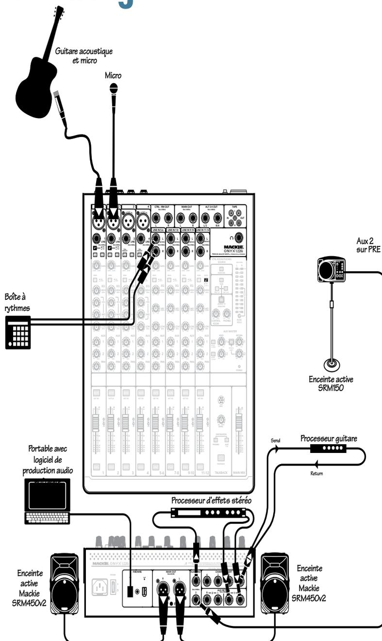
Ce schéma montre une guitare acoustique sonorisée connectée à l'entrée 1 et un micro connecté à l'entrée 2 pour le chant. Un processeur d'effets est connecté à l'embase Insert de la voie 1.
