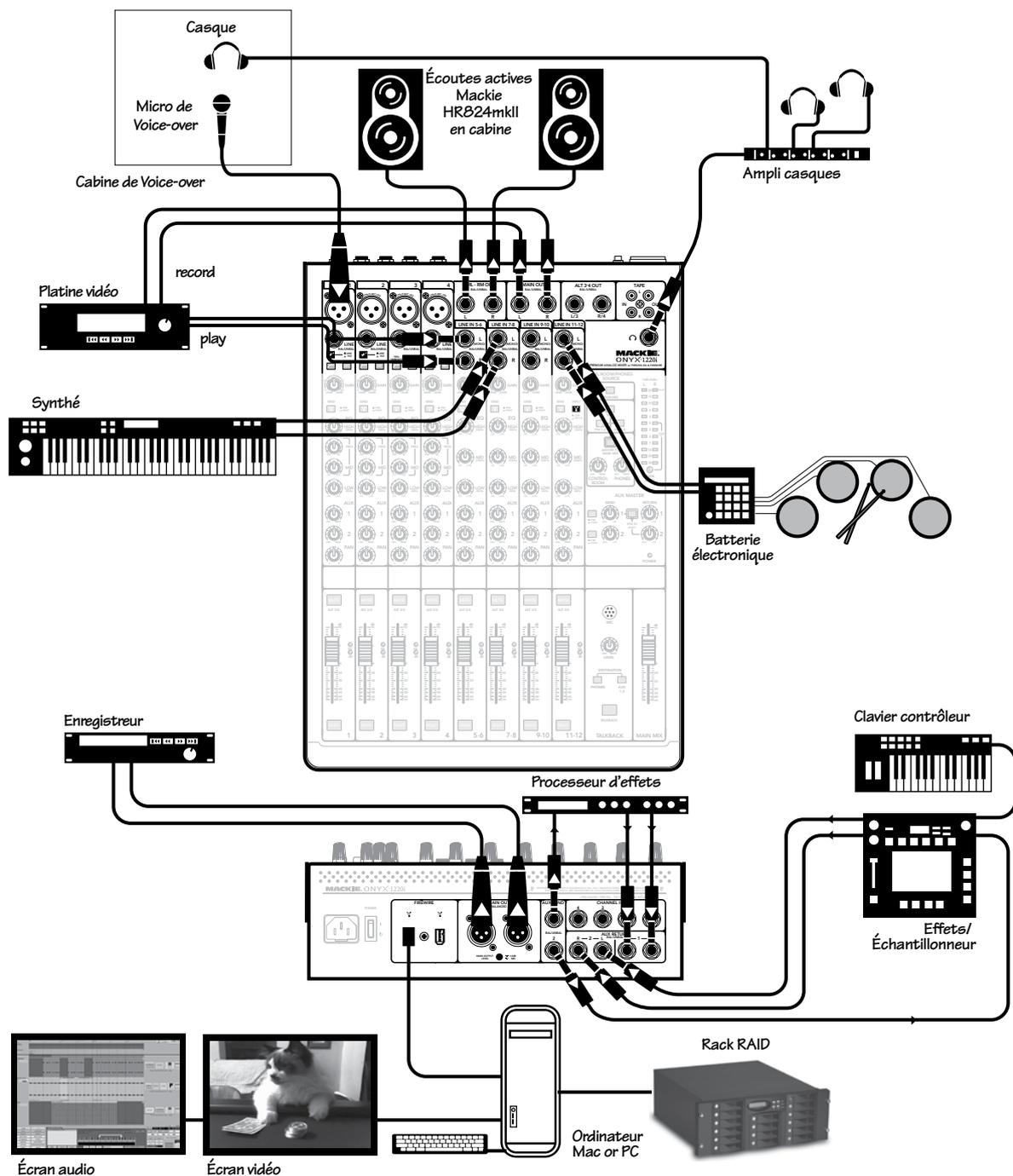
Ce schéma montre un micro connecté à l'entrée micro de la voie 1, une platine vidéo connectée aux voies 5 et 6 et dont les entrées audio sont connectées aux sorties Main Mix jack 6,35 mm. Un synthétiseur est connecté aux voies 7 et 8 et une batterie électronique est connectée aux voies 11 et 12.
