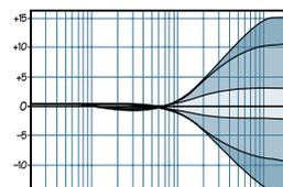
Lorsque vous avez choisi la fréquence, le niveau de l'égaliseur des fréquences médiums peut être réglé avec le potentiomètre de niveau.
