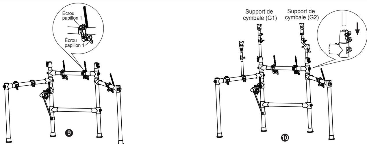
9. Fixez les Pads aux pinces du tube central (1), du tube latéral (G2), du tube latéral (D), et serrez fermement les écrous papillon 1.
