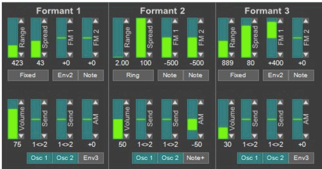
Le Scrooo dispose de trois générateurs de formants avec des fréquences centrales individuelles et des largeurs de bande. De plus, la fréquence centrale et l'amplitude de chaque formant peut être modulée par diverses sources de modulation.
