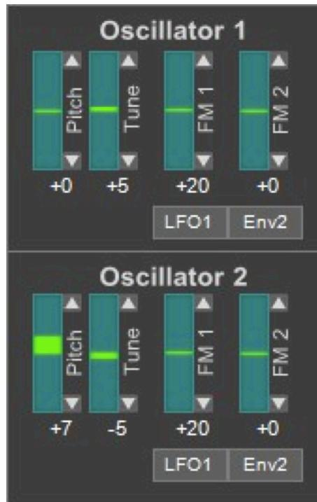
Chaque oscillateur du Scrooo produit une forme d'onde sinusoïdale qui alimente les trois générateurs de formants pour créer des spectres de signaux plus complexes. La fréquence des deux oscillateurs peut être modulée indépendamment par deux sources de modulation différentes (unipolaire ou bipolaire, voir la liste des sources de modulation).
