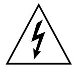
Dieses Symbol verweist auf nicht-isolierte Stromspannungen im Geräte-Innern, welche zu einem elektrischen Schlag führen könnten.
