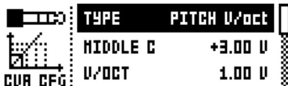
TYPE は、出力から送信される信号の種類を選択します。GROUNDED、PITCH V/OCT、PITCH HZ/V、VALUE LIN、TRIG、GATE の設定を行うことができます。選択に応じて、異なるパラメーターを利用できません。
