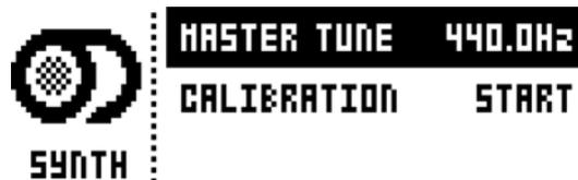
**MASTER TUNE** は、アナログオシレーターのマスターチューニングを設定します。デフォルトの設定は、440.0Hz です。
