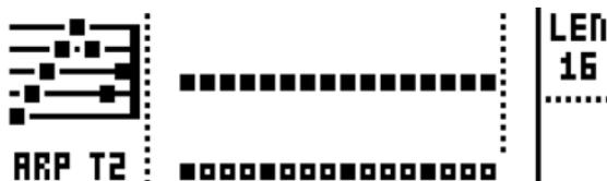
E ノブを回して、アルペジオの長さを選択します。最大の長さは、16 シーケンサーステップです。<TRIG LEDS> は、アルペジオの長さを示しています。アルペジオが再生される際に、再生されるアルペジオのノート数です。
