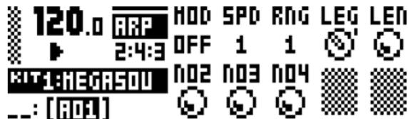
MOD は、アルペジエーターをオンにして、アルペジオされるノートの格納法をコントロールします。
