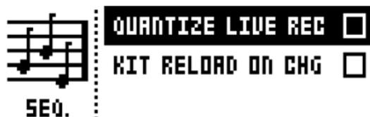
QUANTIZE LIVE REC がオンの場合、LIVE RECORDING モードで入力されたノートをクオンタイズして、シーケンサーのステップを完成します。設定がオフの場合は、ライブレコーディングされたノートはマイクロタイミングの影響を受けます。マイクロタイミングの詳細については、37 ページの「NOTE メニュー」のセクションを参照してください。
