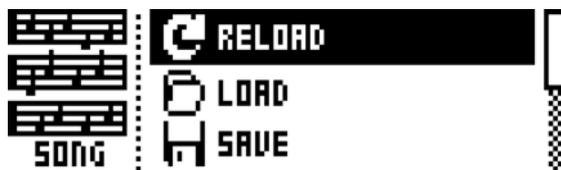
**RELOAD** は、アクティブなソングをリロードします。保存されたバージョンでリストアされます。このコマンドのショートカットとして、[NO/RELOAD] キー + [SONG] キーを押します。
