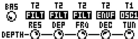
パフォーマンスマクロには、最大5つまでのトラックパラメーターを割り当てることができます。6つのトラック全からのパラメーターを利用できます。**DATA ENTRY** ノブ A-E をクリックして押して、トラックパラメーターを割り当てられるトラックを選択します。**DATA ENTRY** ノブ A-E を回して、割り当てられるトラックパラメーターを選択します。**[YES/SAVE]** キーを押して選択を確定します。**DATA ENTRY** ノブ F-J は、5つのトラックパラメーターのデプスの設定に使用されます。デプスは、オリジナルのトラックパラメーター値に対するオフセットです。
