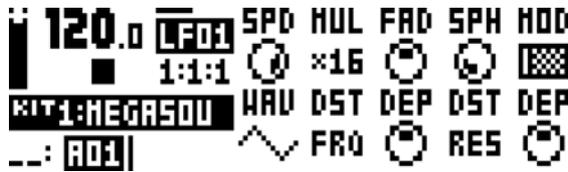
**SPD** (LFO1 の速度) は、LFO1 の速度をコントロールします。BPM に同期します。LFO1 がストレートなビートに同期する場合、16、32、64 の設定を試してください。値は二極性です。つまり LFO の形状は、負の値を使用して逆再生することが可能です。
