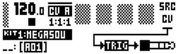
**SRC** (ソーストラック) は、トリガー信号の送信に使用されるノートのトラックを選択します。CV トラック、FX トラック、シンセトラック 1-4 をソースとして使用できます。
