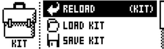
RELOAD KIT は、保存された状態に戻すために、アクティブなキットと全てのキットのどちらかをリロードします。**[LEFT]** キーと **[RIGHT]** キーを使用して、アクティブなキットのみ、または全てのキットがリロードされるように選択できます。**[NO/RELOAD]** キー + **[KIT]** キーは、アクティブなキットをリロードするためのショートカットです。
