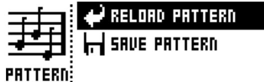
**RELOAD PATTERN** は、アクティブなパターンをリロードします。オリジナルの自動保存された状態と、**SAVE PATTERN** コマンドを利用して決定できる特定の保存状態のどちらかがリロードされます。**RELOAD PATTERN** コマンドのショートカットとして、**[NO/RELOAD]** キー + **[PATTERN]** キーを押します。
