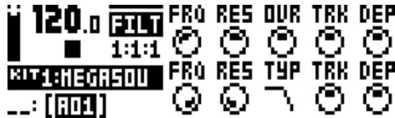
6. シーケンサーの最初のステップにノートトリガーを入力します。アンプエンベロープをトリガーすることが必要です。
