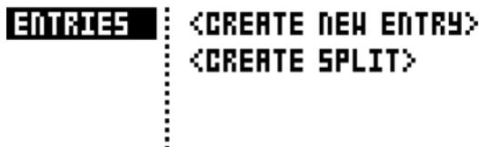
ENTRIES は、マルチマップの基本的な構造ブロックです。各鍵盤または鍵盤の範囲に割り当てられる機能を定義します。マルチマップごとに、最大 128 までのエントリーを作成できます。エントリーが存在していない場合、ENTRIES を選択してから、**CREATE NEW ENTRY** を選択します。全てのエントリーを消去して改めて開始したい場合、ENTRIES を選択してから、**CLEAR ALL ENTRIES** を選択します。デフォルトのマルチマップ、キーボードスプリットを使用したい場合、全てのエントリーをクリアしてから **CREATE SPLIT** を選択します。[UP]/[DOWN] 矢印キーまたは SOUND SELECTION ホイールを使用してから [YES/SAVE] を押して、ディスプレイの左側の部分で編集するエントリーを選択します。カーソルは、マッピングの選択肢のリストが表示される、ディスプレイの右側に移動します。
