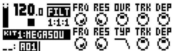
**FRQ** (フィルター1の周波数)は、フィルター1のカットオフ周波数をコントロールします。4バンドのローパストランジスタラダー型フィルターです。
