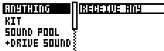
左側の列は、受信する内容を選択します。**[LEFT]** 矢印キーを使用して、列を選択します。**[UP]/[DOWN]** キーを使用するか、**SOUND SELECTION** ホイールを使用して、列をスクロールします。右側の列の選択肢を受信する SysEx データは、左側の列での選択に応じて変化します。**[RIGHT]** 矢印キーを押して、この列にアクセスします。**[UP]/[DOWN]** キーを使用するか、**SOUND SELECTION** ホイールを使用して、受信する内容を選択します。**[YES/SAVE]** キーを押して、SysEx の受信手順を開始します。Analog Keys は、受信データのリスニングを開始します。**[NO/RELOAD]** キーを押して、リスニングを停止します。
