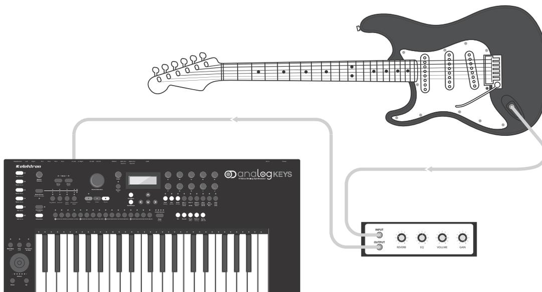
このセットアップ例では、エレクトリックギターからのサウンド出力の処理に Analog Keys を使用しています。最初のもっとも基本的な方法では、FXトラックを使用して、Analog Keys を Wideshift Chorus、Saturator Delay、Supervoid Reverb エフェクトなどのエフェクトボックスに切り替えます。2 番目のよりこった方法では、サウンドを Track1 からルーティングして、FILTERS、AMP、ENV、LFO によって提供される全てのサウンド形成機能を使用可能にします。
