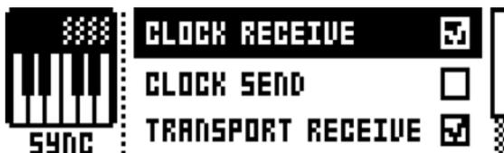
**CLOCK RECEIVE** がオンの場合、Analog Keys が外部機器から送信された MIDI クロックにตอบสนองするようにします。
