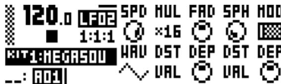
**SPD** (LFO2の速度) は、LFO2の速度をコントロールします。BPMに同期します。LFO2がストレートなビートに同期する場合、16、32、64の設定を試してください。値は二極性です。つまりLFOの形状は、負の値を使用して逆再生することが可能です。
