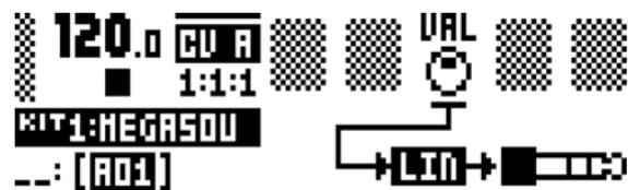
**VAL** (値) は、CVの電圧レベルを設定します。選択した CV のタイプが VALUE LINである場合に適用します。
