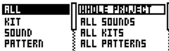
左側の列は、バックアップする内容を選択します。[LEFT] 矢印キーを使用して、列を選択します。[UP]/[DOWN] キーを使用するか、SOUND SELECTION ホイールを使用して、列をスクロールします。右側の列の選択肢を送信する SysEx データは、左側の列での選択に応じて変化します。[RIGHT] 矢印キーを押して、この列にアクセスします。[UP]/[DOWN] キーを使用するか、SOUND SELECTION ホイールを使用して、送信される内容を選択します。[YES/SAVE] キーを押して、SysEx の送信手順を開始します。
