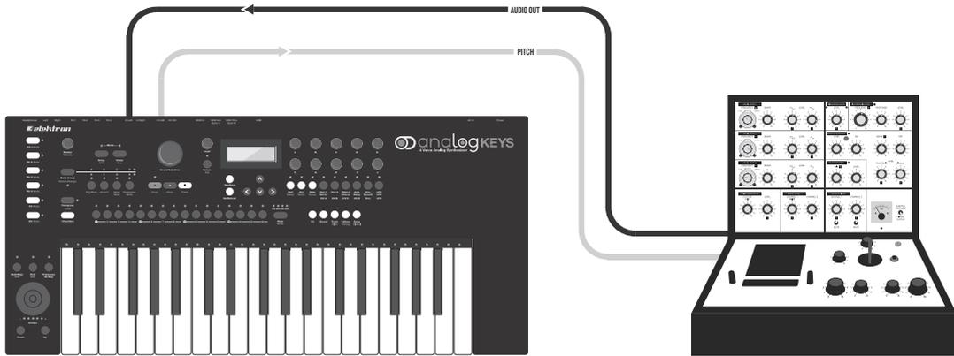
CV/Gate 出力と外部入力によって、外部オシレーターを Analog Keys の内部オシレーターと同時に使用できます。この方法を使用して、様々な (古くて気まぐれで予測不能な動作をしてもやはり魅力的である) オシレーターで基音を生成して、さらに Analog Keys のコントロールやモジュレーションのパワーを利用できます。
