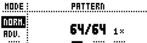
最初の 2 つの設定では、パターンのステップの長さをコントロールします。一番左側の数値は、パターンでのステップ数を選択します。パターンに利用可能なステップの最大数は、全体の長さによって決定され、右側のパラメーターで設定されます。これは、16、32、48、64 ステップのいずれかです。パターン内で 17 以上のステップが使用されている場合、GRID RECORDING モードでは、**[PAGE]** キーを使用して異なるパターンページを切り替えます。
