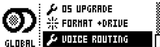
メイン出力と FXトラックへの 4 ボイスの全てのルーティングをオン/オフします。**[ARROWS]** キーを使用して移動します。**[YES/SAVE]** キーを押して、ボックスをオン/オフします。
