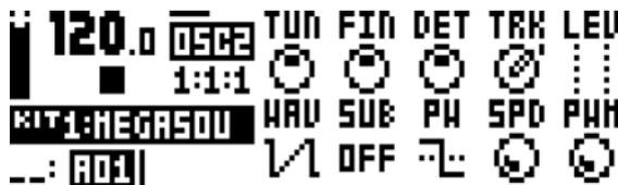
**TUN** (OSC2 コースチューニング) は、半音単位でオシレーターのピッチを設定します。オクターブ全体をジャンプするには、ノブを押したまま回します。FIN(OSC2 ファインチューニング) は、オシレーターのピッチをファインチューニングします。複数回このノブを回して、連続して微調整できます。TUN は、全てで FIN がオンの場合、半音単位で増減します。
