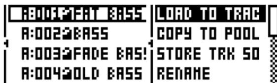
**LOAD TO TRACK** は、選択したサウンドをアクティブなトラックにロードしてから、アクティブなキットの一部にします。
