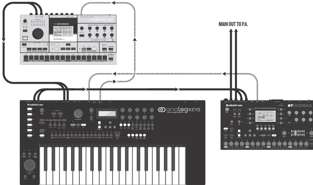
Analog Keys は、実際には他の Elektron の機器と組み合わせることで可能性が広がります。この例では、Octatrack、Machinedrum とともに使用しています。Machinedrum のメイン出力は、Analog Keys の入力に接続されています。Analog Keys のメイン出力は、Octatrack の入力ペアのいずれかに接続されています。Octatrack のメイン出力は、PA に接続されています。Machinedrum と Analog Keys は、Octatrack の MIDI スレーブです。
