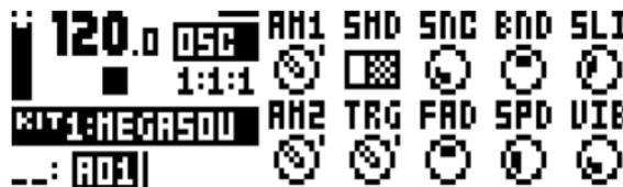
**AM1** (OSC1 の AM) は、オシレーター1のアンプモジュレーションと連動しています。これは、オシレーター2のパルス波形によって信号が (複数回) オン/オフされることを意味しています。これによって、2 つのオシレーターの合計周波数による倍音と、異なる周波数の倍音が導入されます。結果は、リングモジュレーションになり、メタリックで中空で不調和なサウンド品質が得られます。オシレーターからのサウンドが聞こえていない場合でも、オシレーター2の波形とパルス幅が結果に影響することに注意してください。
