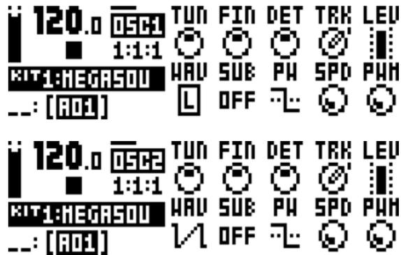
7. これでトラック 1 上のノートトリガーで、内部と外部の両方のオシレーターをコントロールできます。
