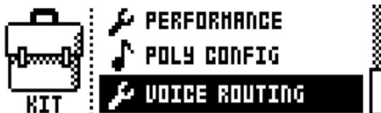
メイン出力と FX トラックへの 4 ボイスのルーティングをオン/オフします。**[ARROWS]** キーを使用して移動します。**[YES/SAVE]** キーを押して、ボックスをオン/オフします。
