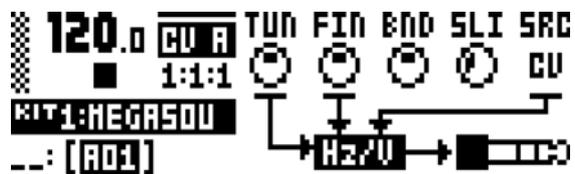
**TUN** (コースチューニング) は、半音単位で CVのコースチューニングを設定します。
