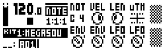
NOTE メニュー設定にあるパラメーター設定は、シーケンサーにトリガーを入力する際のデフォルトの設定です。3 つのノートトリガーを入力して、例えばノートの長さのパラメーターを変更してから、さらに 3 つのノートトリガーを入力すると、最後の 3 つのノートトリガーは、最初の 3 つと比較して異なるノートの長さを共有します。ノートごとに個別の設定を追加するには、パラメーターロックを利用します。この機能「パラメーターロック」の詳細については、40 ページを参照してください。μTM、ENV、LFO の設定は、パラメーターがロックされている場合に限り変更できます。
