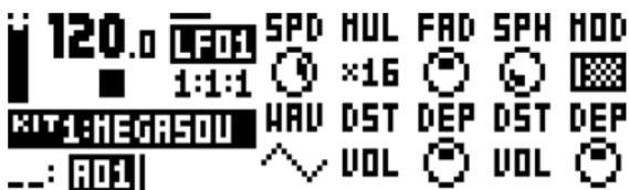
**SPD** (LFO1の速度) は、LFO1の速度をコントロールします。BPMに同期します。LFO1がストレータなビートに同期する場合、16、32、64の設定を試してください。値は二極性です。つまりLFOの形状は、負の値を使用して逆再生することが可能です。
