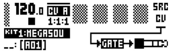
**SRC** (ソーストラック) は、ゲート信号の送信に使用されるノートのトラックを選択します。CV トラック、FX トラック、シンセトラック 1-4 をソースとして使用できます。
