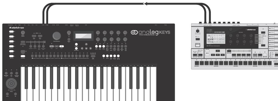
隣接ルーティングのおかげで、Analog Keys の全てのフィルターを、8つのフィルター回路と4つのオーバードライブ回路から構成された膨大なモノラルフィルターバンクを提供するように使用できます。セットアップは、直列と並列のどちらも可能です。もちろん、ステレオフィルターも同様にセットアップできます。このシナリオでは、左右のチャンネルに4つのフィルターを利用しています。
