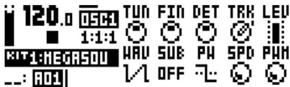
**TUN** (OSC1 のコースチューニング) は、半音単位でオシレーターのピッチを設定します。オクターブ全体をジャンプするには、ノブを押したまま回します。
