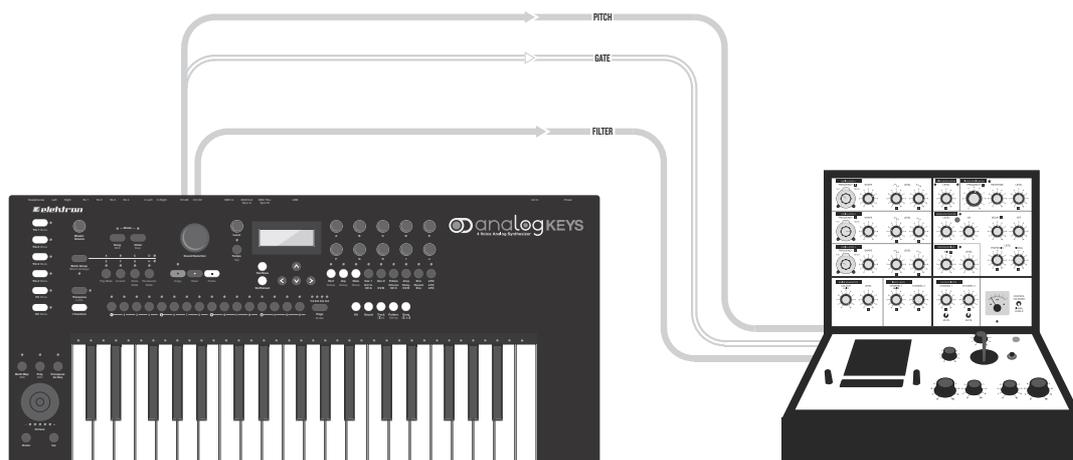
Analog Keys の CV/Gate トラックは、CV/Gate が搭載された外部のアナログ機器のコントロール用に作成されています。このシナリオでは、ビンテージのアナログシンセサイザーを Analog Keys でコントロールします。ピッチとフィルターのカットオフをコントロールします。
