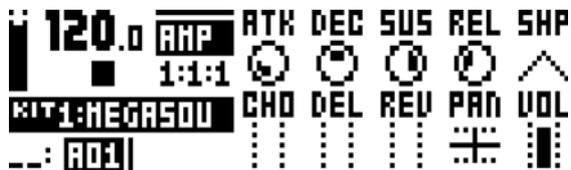
**ATK** (EnvAのアタック)は、EnvAエンベロープのアタックタイムをコントロールします。これは、トラックのアンプ (増幅) をコントロールします。
