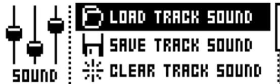
LOAD TRACK SOUND では、最大 128 の保存されたサウンドから 1 つのサウンドをロードします。サウンドは、アクティブなシンセ・トラックにロードされ、アクティブなキットの一部となります。メニューを開くとサウンド・リストが表示されます。
