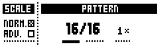
PATTERN では、パターンの長さや拍子が設定されます。左側の数字は、パターンのステップ数を設定します。パターンで設定可能なステップの最大数は、右側のパラメーターで設定されている長さにより異なります。右側のパラメーターは、16、32、48、64 ステップのいずれかになります。パターンで 17 ステップ以上が使用されている場合、GRID RECORDING モードでは、異なるパターン・ページ間を切り替えるために [PAGE] キーを使用します。
