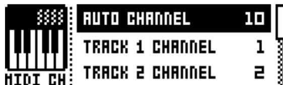
AUTO CHANNEL は、現在アクティブなトラックへのアクセス権を与える MIDI チャンネルを選択します。Analog Four に接続した外部 MIDI キーボードがこのチャンネルで MIDI データを送信する場合、キーボードがアクティブなトラックをコントロールします。これは、例えば異なるサウンドを再生させるために、アクティブなシンセ・トラック間の迅速な変更の有効です。
