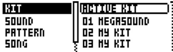
左側のカラムは、何を受信するかを選択します。[LEFT] の矢印キーを使用してカラムを選択します。[UP]/[DOWN] キーまたは LEVEL ノブを使って、カラムを移動します。SysEx データは、左のカラムで選択した項目に応じて変更する、右側に位置するカラムの選択肢を受信します。このカラムにアクセスするには、[RIGHT] の矢印キーを押します。[UP]/[DOWN] キーまたは LEVEL ノブを使用して、何を受信すべきかを選択します。[YES/SAVE] を押して、SysEx の受信処理を開始します。Analog Four は、受信データのリスニングを開始します。リスニングを停止するには、[NO/RELOAD] を押します。
