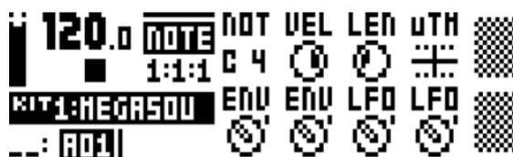
シーケンサーでトリガを配置するとき、NOTE メニュー設定で表示されるパラメーター設定は、デフォルト設定です。例えば、3 つのノート・トリガを入力した後に、ノート・レンジ・パラメーター設定を変更し、さらに 3 つのノートを入力した場合は、最初の 3 つのノート・トリガと次の 3 つのノートは異なるノート・レンジとなります。ノートごとに個別の設定を追加するには、パラメーター・ロックを使用します。この機能については、24 ページの PARAMETER LOCKS をご覧ください。
