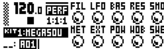
利用可能な 10 のパフォーマンス・マクロは Performance メニューで表示されます。パラメーター・マクロ設定を調整するには、DATA ENTRY ノブを回します。
