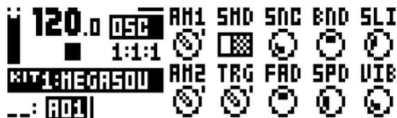
AM1 (Osc1 AM) は、オシレーター 1 のアンプ・モジュレーションを組み合わせ、その信号は、オシレーター 2 のパルス・ウェーブによってオン/オフ (乗算) を切り替えられます。これは、合計された周波数と新たなハーモニクスと 2 つのオシレーターのハーモニクスの周波数の違いを表しています。この結果は、リング・モジュレーションに関係しており、メタリック、ホロー、もしくは不協和音な音質を与えることができます。オシレーター 2 のウェーブ・フォームやパルス・ワイズもまた、そのオシレーターが聞こえなくとも、結果に影響を与えることに注意してください。
