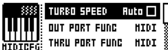
TURBO SPEED は、Analog Four MIDI IN/OUT ポートが、ターボ・プロトコル対応機器の MIDI OUT/IN ポートに接続されている場合、使用する MIDI 転送速度のマルチ・プライヤーを設定します。[LEFT]/[RIGHT] の矢印キーは、マルチ・プライヤーを選択するために使用されます。AUTO を選択した場合は、[YES/SAVE] を押してターボ・スピード・ネゴシエーションを開始します。
