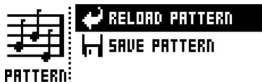
RELOAD PATTERN は、アクティブ・パターンをリロードします。元の自動保存状態もしくは SAVE PATTERN コマンドを使用して保存した特定の保存状態にリロードされます。RELOAD PATTERN コマンドへショートカットするために、[NO/RELOAD] + [KEYBOARD F1] を押します。
