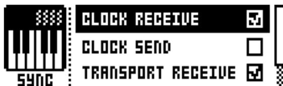
CLOCK RECEIVE がアクティブの場合、外部装置から送信された MIDI クロックを Analog Four へ応答させます。
