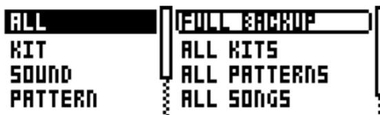
左側のカラムは、バックアップする内容を選択します。[LEFT] の矢印キーを使用してカラムを選択します。[UP]/[DOWN] キーまたは LEVEL ノブを使って、カラムを移動します。SysEx データは、左のカラムで選択した項目に応じて変更する、右側に位置するカラムの選択肢を送信します。このカラムにアクセスするには、[RIGHT] の矢印キーを押します。[UP]/[DOWN] キーまたは LEVEL ノブを使用して、何を送信すべきかを選択します。[YES/SAVE] を押して、SysEx の送信を開始します。
