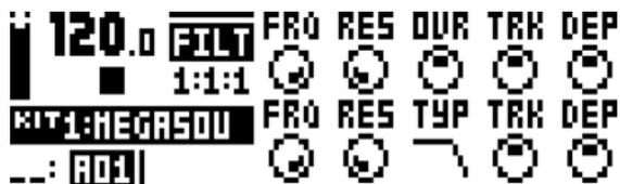
FRQ (フィルター 1 周波数) は、4 ポール・ローパス・トランジスタ・ラダー・フィルターであるフィルター 1 のカットオフ周波数をコントロールします。カットオフされた周波数は、カットオフ以下の周波数がフィルターを通過する間、ダンブされます。
