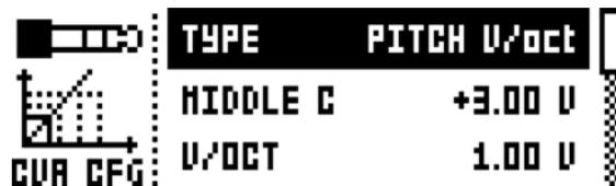
TYPE は、アウトプットから送信されるべき信号の種類を選択します。PITCH V/OCT や PITCH HZ/V、VALUE LIN、TRIG GATE、CLOCK の設定を行うことができます。
