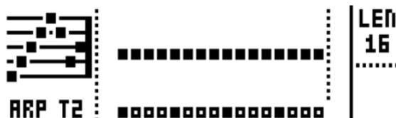
E のノブを回して、アルペジオの長さを選択します。レンジは、最長で 16 のシーケンサー・ステップです。
