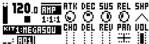
ATK (EnvA アタック) は、トラックのアンプをコントロールする EnvA エンベロープのアタック・タイムをコントロールします。
