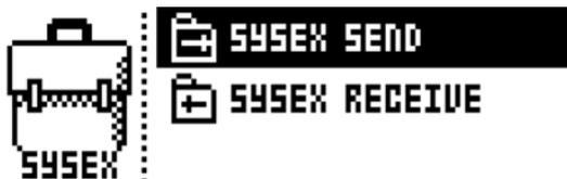
SysEx データを受信または送信する際、Analog Four の MIDI ポートまたは USB ポートは、外部の送信 / 受信デバイスに接続される必要があります。外部デバイスがコンピュータである場合、Elektron のウェブサイトからダウンロードできる弊社の無料の SysEx ユーティリティ C6 を使用することをおすすめします。
