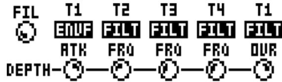
最大で5つのトラック・パラメーターを、パフォーマンス・マクロにアサインできます。パラメーターは、6つのすべてのトラックから用いることができます。**DATA ENTRY** ノブ A-E を押して、トラック・パラメーターのアサインに用いるトラックを選択します。**DATA ENTRY** ノブ A-E を回して、アサインするトラック・パラメーターを選択します。**DATA ENTRY** ノブ F-J は、5つのトラック・パラメーターのデプスの設定に使用されます。デプスは、元のトラック・パラメーター値へのオフセットです。
