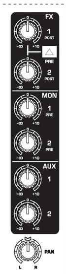
Las líneas de transmisión auxiliares FX, MON y AUX le ofrecen la posibilidad de desacoplar las señales de uno o varios canales y transmitir las a una serie de salidas adicionales. De este modo podrá crear mezclas independientes para efectos (FX) o para los músicos sobre el escenario (MON). Mediante las salidas FX/MON/AUX-Send, esta mezcla se transmite a los altavoces del escenario o a los aparatos de efectos.
