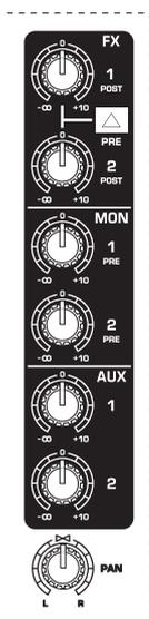
Les départs **FX**, **MON** et **AUX** permettent de découpler les signaux d'un ou plusieurs canaux et de les conduire vers diverses sorties supplémentaires. Ainsi, vous pouvez réaliser des mixages indépendants pour alimenter des effets (**FX**) ou des retours de scène (**MON**). Les sorties **FX/MON/AUX SEND** permettent de conduire chaque mixage vers les processeurs d'effets ou les retours de scène.
