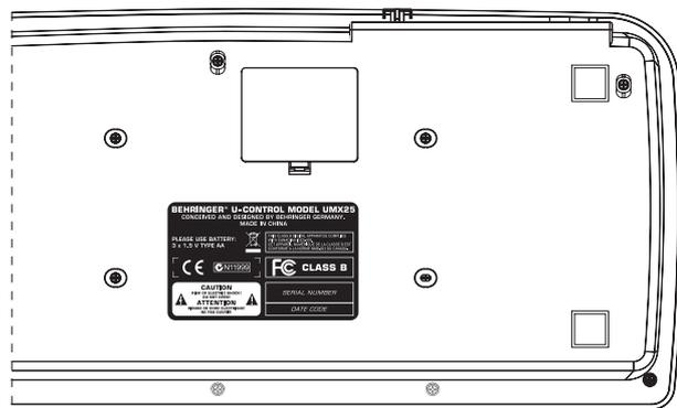
Abbildung 1.2: Das Batteriefach auf der Unterseite des UMX
