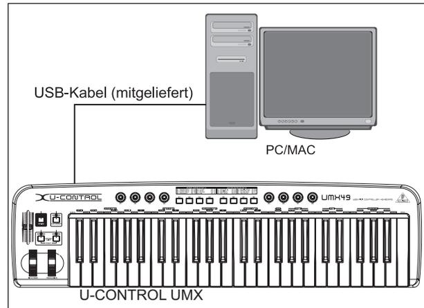
Abbildung 1.1: Stromversorgung via USB
