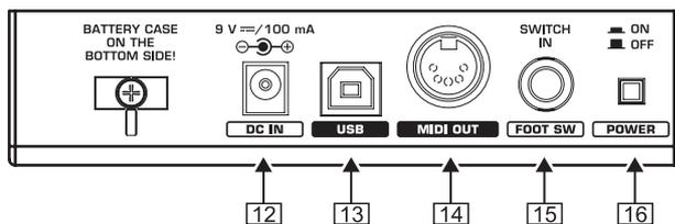
Abb. 3.2: Die Anschlüsse auf der Rückseite
