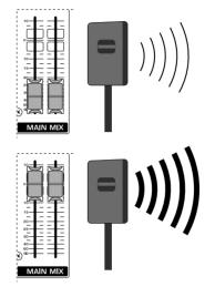
使用通道的 AUX 旋钮和主 AUX SEND 旋钮将通道信号发送到连接 AUX SEND 端的效果处理器或监听音箱。如果是将信号发送到效果处理器的话,信号会返回到其中一个 AUX RETURN 端。
