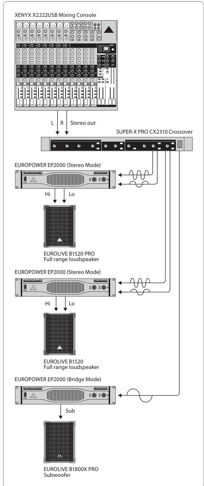
Fig. 3.7: Modo de Bi-Amp estereofónico com Subwoofer separado
