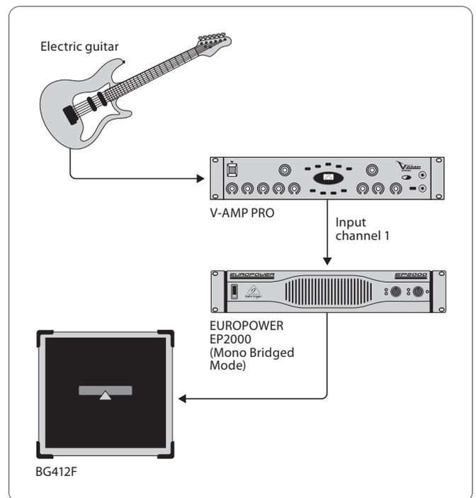
Fig. 3.5: Modo de operação em ponte mono
