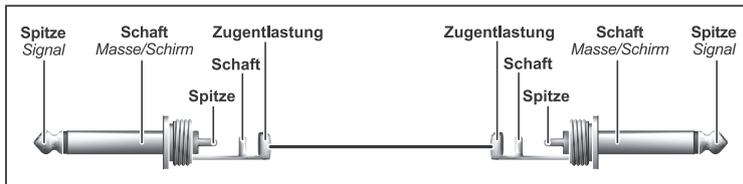
Abb. 9.1: Unsymmetrisches Klinkenkabel mit 6,3-mm-Monoklinkensteckern
