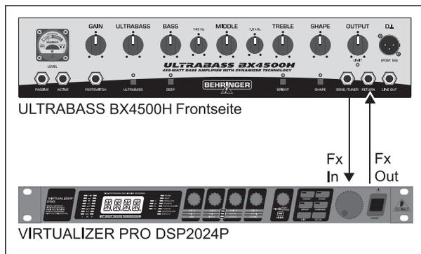
Abb. 3.4: Anschluss eines Multieffektprozessors
