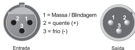
No caso de um modo de operação assimétrico efectuar a ponte entre os pinos 1 e 3.
