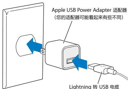
**【警告】**请确定电源适配器完全装配好后再将其插入电源插座。
