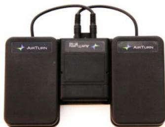
Das BT-105 oder DIGIT kann mit zwei leisen ATFS-2 Fußschaltern gekauft werden. Dieses Gerät ist ideal für viele Apps, die zwei Schalter benötigen. Zum Beispiel könnte es mit einem App verwendet werden, um Seiten vorwärts oder rückwärts zu drehen.
